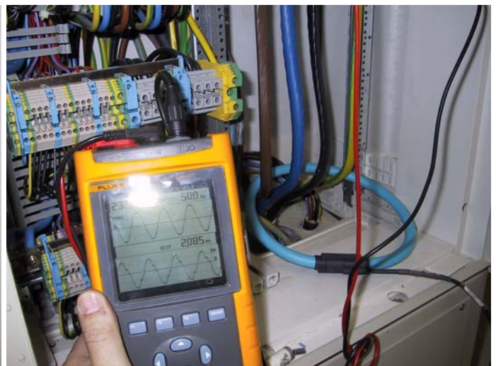
Bild 6 zeigt einen Differenzstrom von 2,08 A
