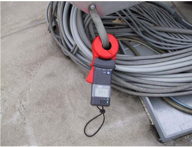
Bild 3 zeigt eine durch verbundene Kabeltrasse, auf dem ein Strom mit 3,65 A fließt und eine Erdungsbrücke an einer Tür
